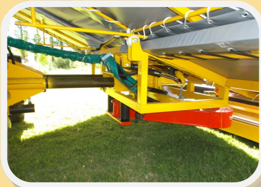
Sistema de sujeción de tronco mediante pinza vibradora con mordazas de goma que evitan daños en la planta
