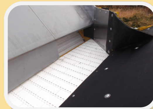
Cinta colectora y elevador con bandas plásticas modulares
