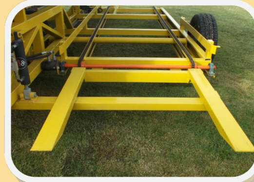
Transporte de bins vacíos y rampa de descarga de bins llenos
