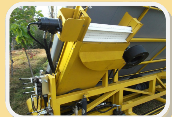
Elevador de descarga con soplador de hojas incorporado
