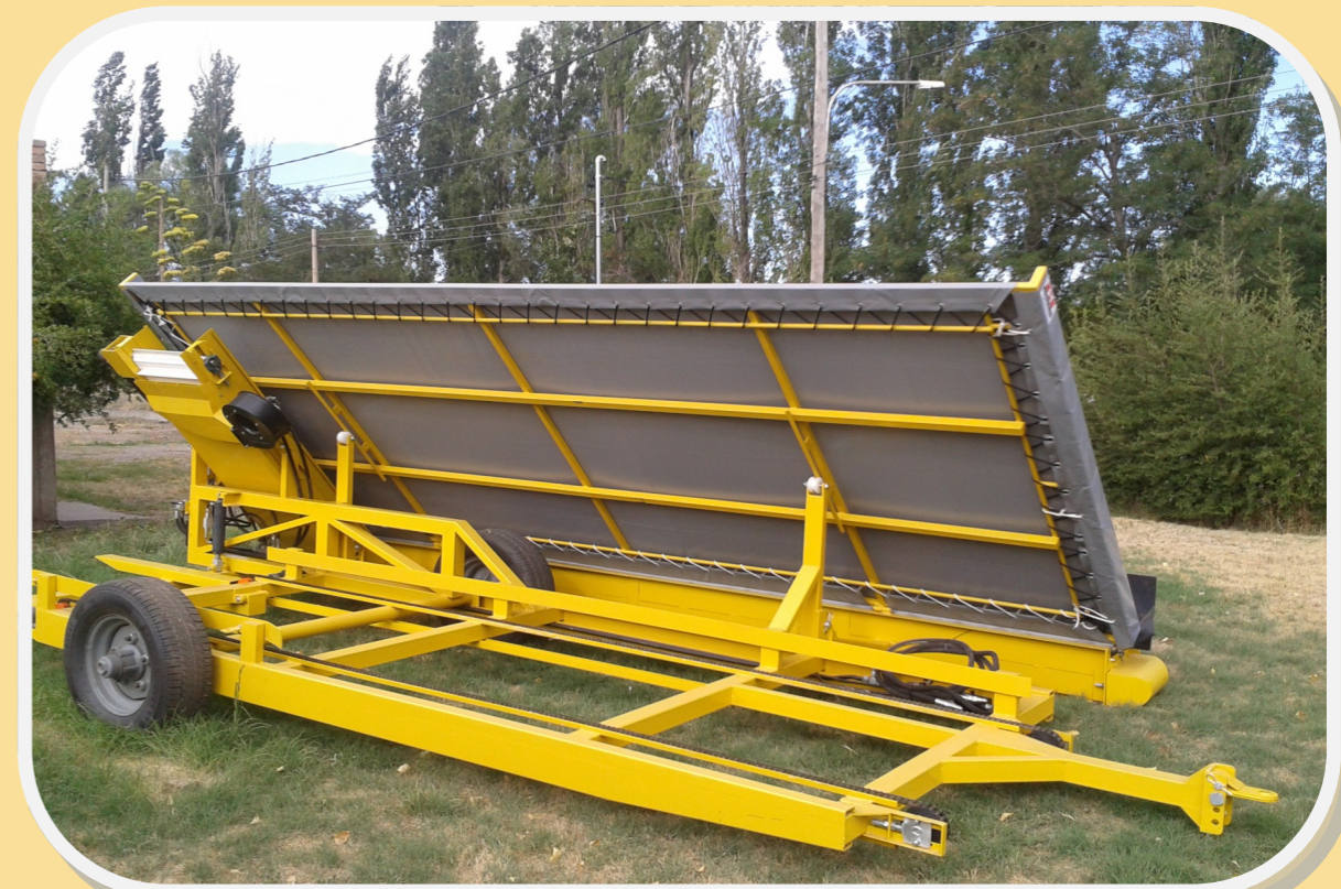
Cinta colectora y elevador con bandas plásticas modulares
